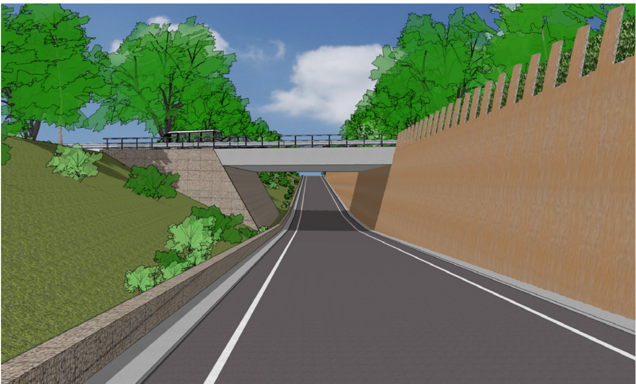
Asymmetrisch profiel, links talud 1:2 met heide en struiken, rechts keerwand met natuurlijke uitstraling. De faunapassage gaat onder de N34 door, en wordt van de weg gescheiden door een rand van schanskorf
