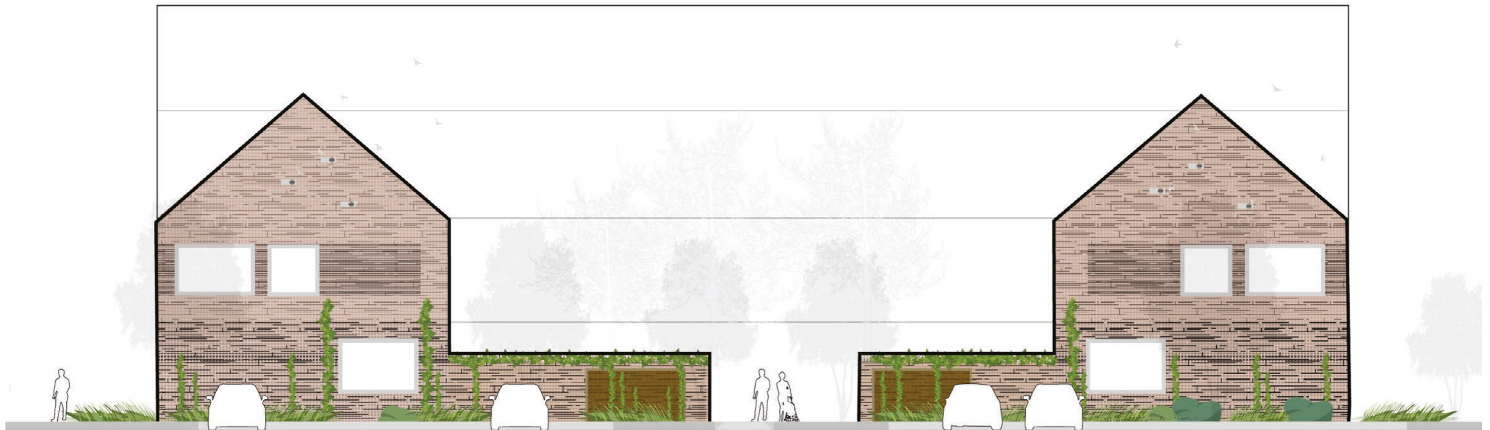
Principe-aanzicht erfafscheiding tuinen in samenhang met het gebouw ontworpen met herkenbare (zij)entree
